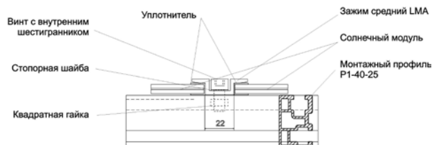
Среднее крепление аморфных модулей
